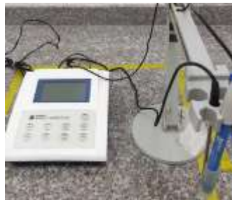
FIGURA 3.4 Potenciómetro y conductímetro (Fuente: Laboratorio de Posgrado VLIR, FCV, ESPOL)
