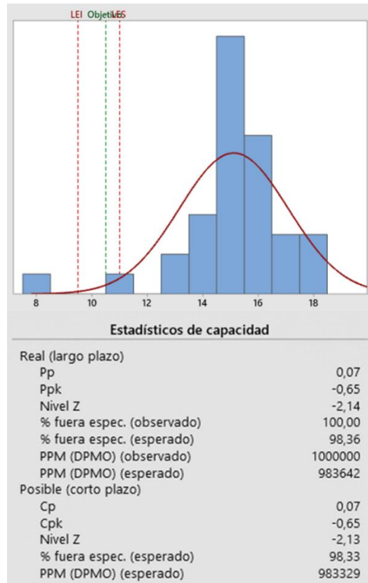
Figura 2.15. Análisis de Capacidad del Proceso de la placa 4209
