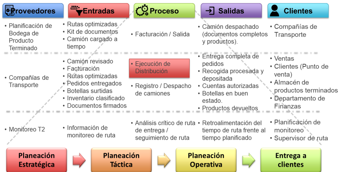
Figura 1.6 Diagrama SIPOC para el proceso de ruta de tripulación
