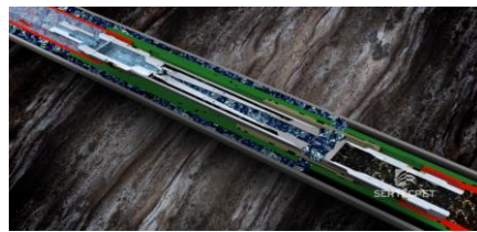
Figura 2. 12 Bomba jet en operación. Fuente: (Sertecpet, 2015)
