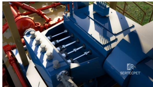
Figura 2. 9 Bomba de superficie, Quintuplex. Fuente: (Sertecpet, 2015).
