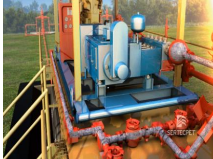
Figura 2. 25 Línea de descarga Fuente: (Sertecpet, 2015)
