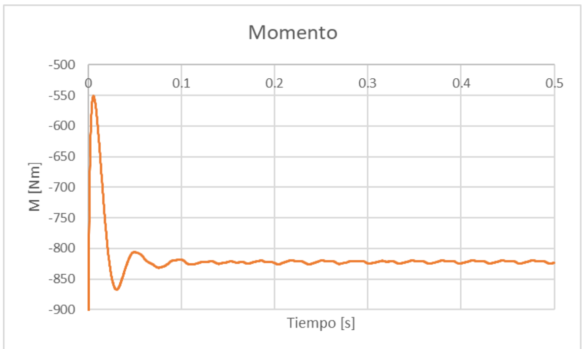
Figura 3.22 Momento [Nm] evaluado en la turbina
