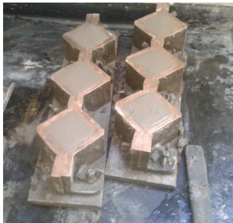
Grafica 3.15: Moldeo de Cubos de Mortero de 50x50x50mm para Temperatura Datum
