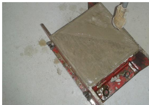
Grafica 3.11: Moldeo de Viga para T= 50°C
