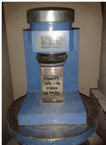
Grafica 3.19: Cubo de Mortero después de Realizar ensayo de Compresión
