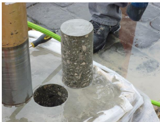
Gráfica 5.12: Núcleo calado de la Losa de Pavimento
