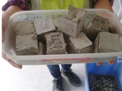
Grafica 3.20: Cubos de Mortero después de Realizar ensayo de Compresión
