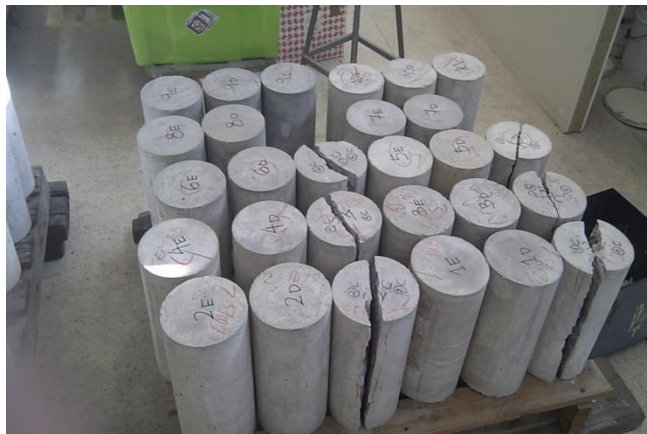
Gráfica 2.5 Cilindros ensayados a Compresión Simple
