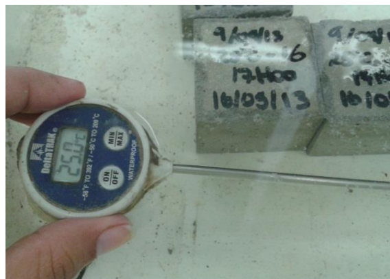
Grafica 3.17: Cubos de Mortero curados a 25°C
