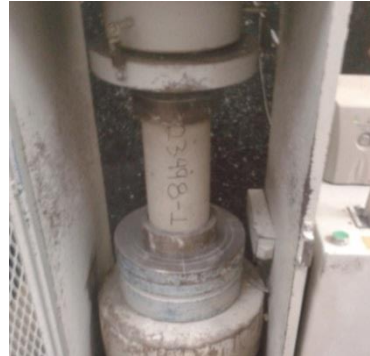
Gráfica 5.11: Cilindro ensayado a Compresión Simple
