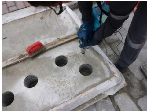
Gráfica 5.13: Esclerometría realizada a la Losa de Pavimento
