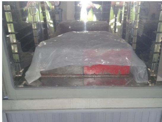
Grafica 3.12: Vigas en horno a T= 50°C
