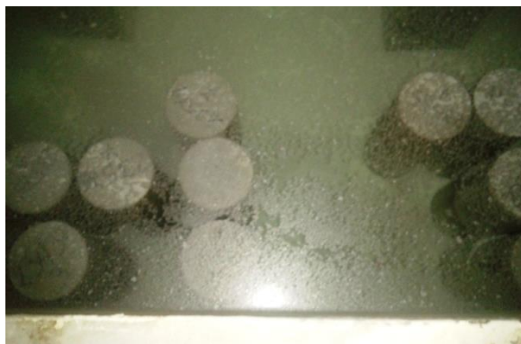
Gráfica 5.18: Cilindros curados en Laboratorio
