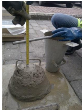
Gráfica 5.1: Ensayo de Asentamiento (Cono de Abrams)
