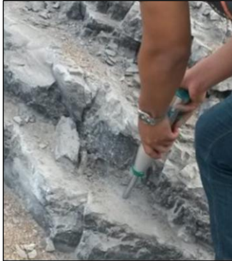
Figura 36 Detalle del esclerómetro o martillo Schmidt (tipo N). Medidas esclerométricas en la superficie de una discontinuidad.
