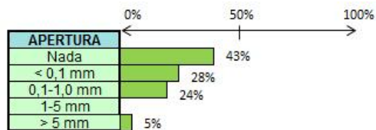
Figura 50 Apertura. Estado de las juntas. Global
