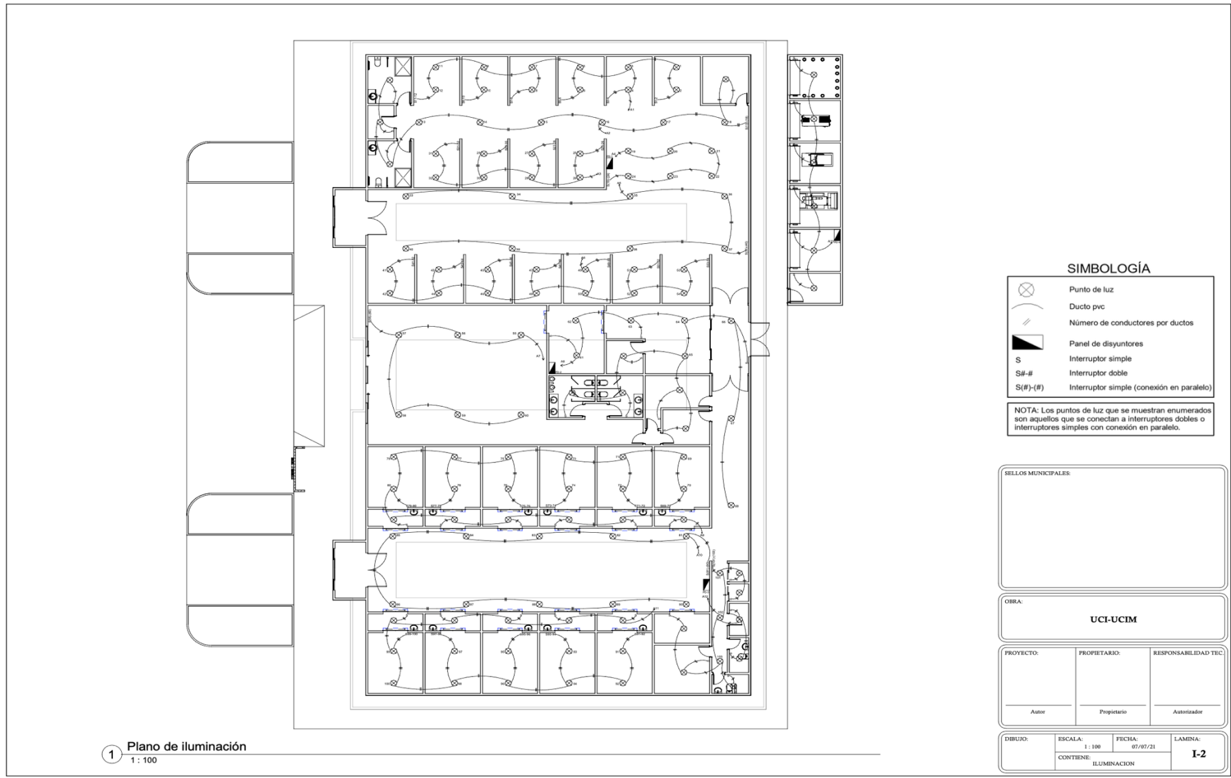
Plano 4.3. Plano del sistema de iluminación de la propuesta, Elaboración propia
