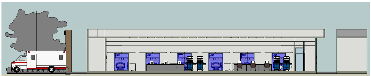
Anexo 3: Corte lateral de UCI, con los ingresos de las pre cámaras
