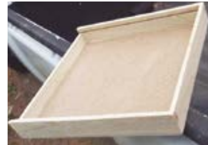
Imagen 52: Construcción caja de luz 33 x 35 cm y 5 cm de alto
