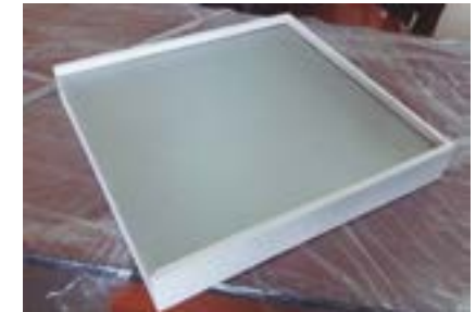
Imagen 52: Construcción caja de luz 33 x 35 cm y 5 cm de alto
