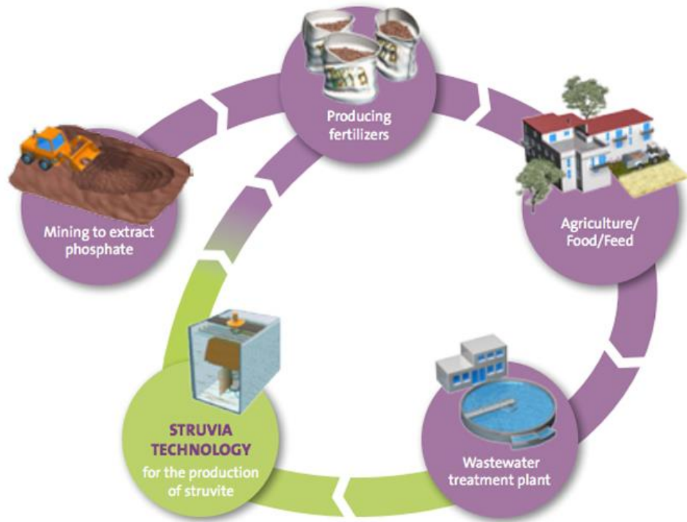
Figura 1.1. Ciclo de vida del fósforo, enfoque de recuperación en forma de estruvita (Veolia WaterTechnologies, 2015).
