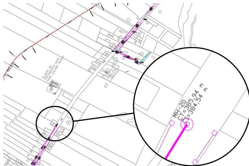
Fig. 4-5 Primera cámara del sistema de conducción #2 (MH-20) - (Fuente: Municipio de Caluma)
