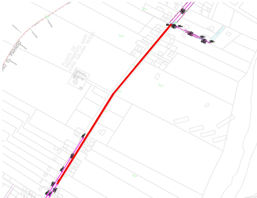
Fig. 5-2 Implantación de trazado de colector de conexión de sistemas (Fuente: Autor)
