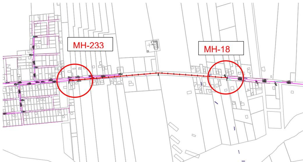
**Fig. 4-6 Esquema de conexión de nueva tubería entre las cámaras MH-18 y MH-233 - (Fuente: Autor)**
