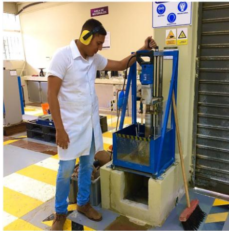
Figura 30: extracción de testigo de roca
