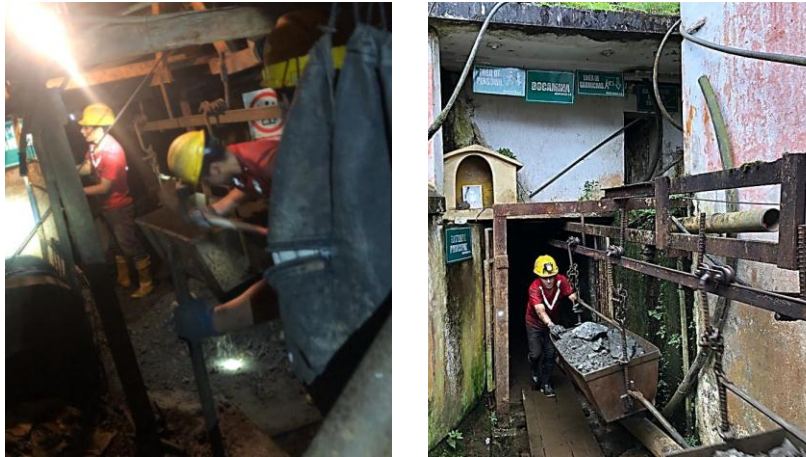
Figura 14 transporte tramo garruchas Fuente: Autores 2019
