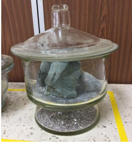
Figura 29: decantador para disminuir la temperatura y evitar que se humedezca
