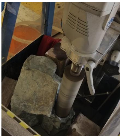
Figura 25: extracción de testigo de roca en la máquina sacadora de núcleos
