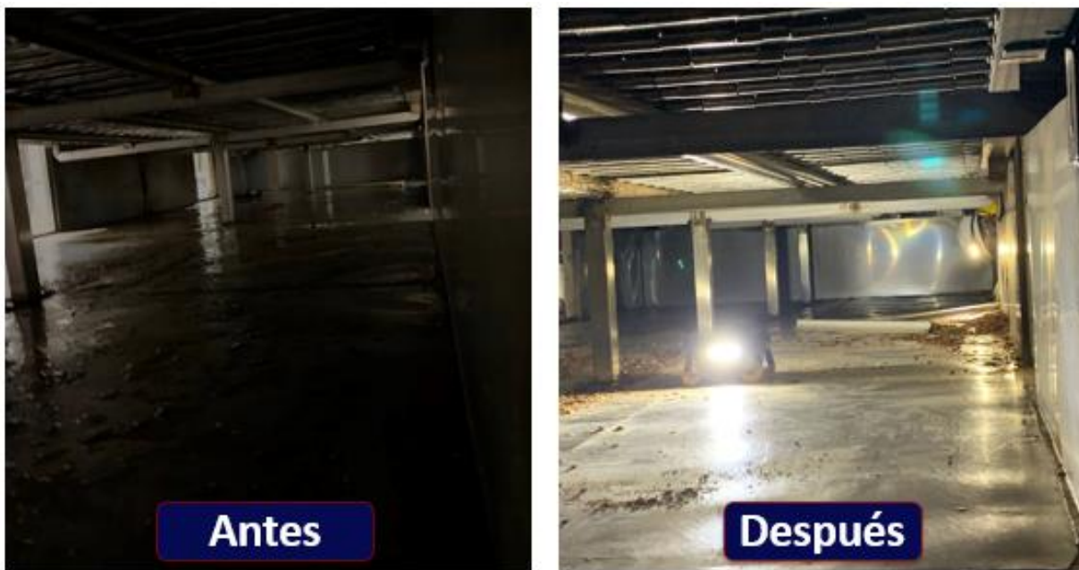
Anexo 19: Resultados de implementar linterna removible en interior de horno
