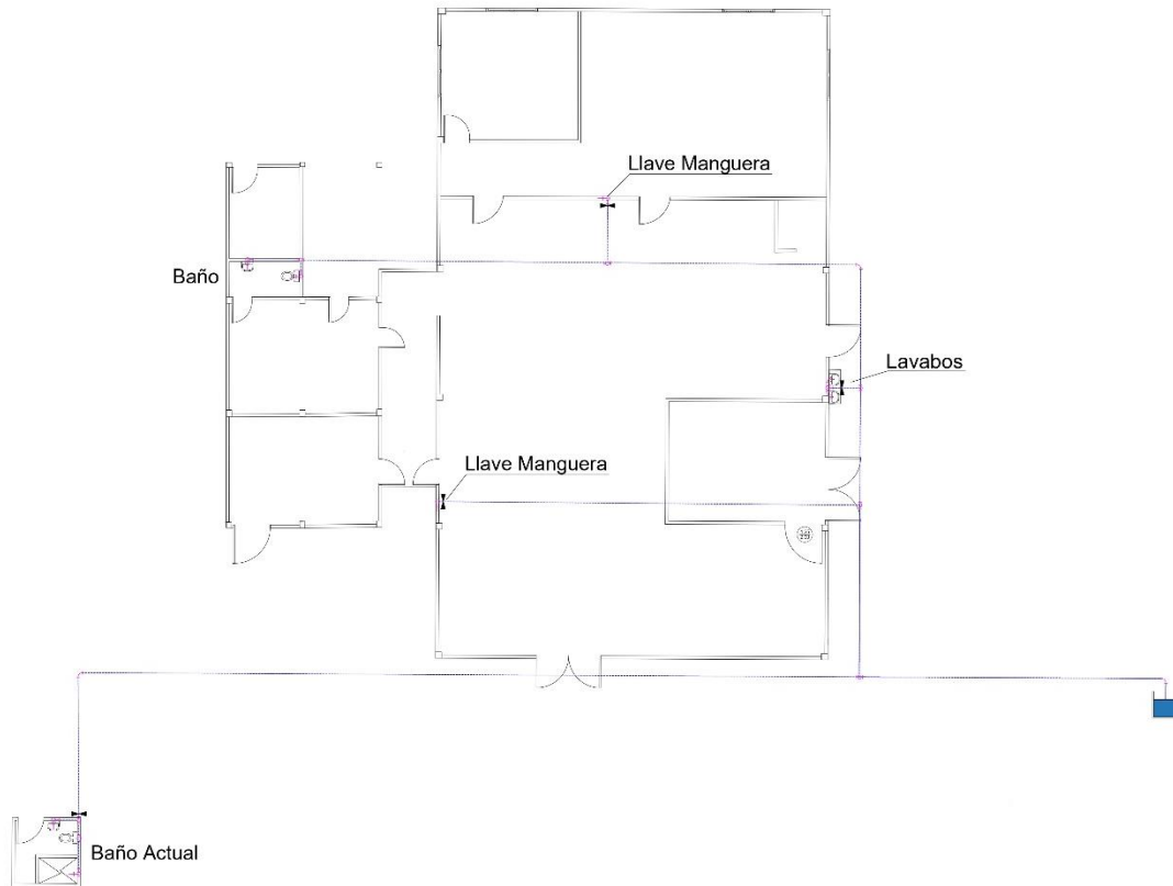
Figura G.1 Distribución de agua. [Pelayo & Ashby, 2020]
