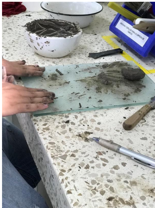
Procedimiento para realizar límite plástico
