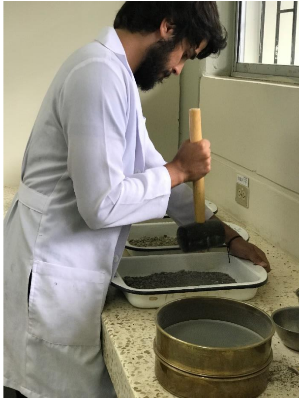
Trituración de la muestra para realizar los límites de Atterberg
