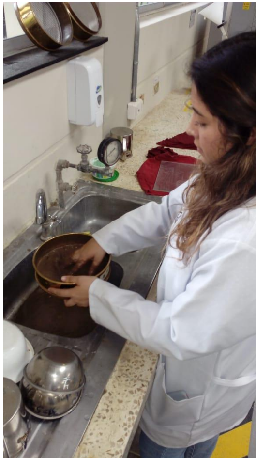
Lavado de la muestra con el tamiz No. 200
