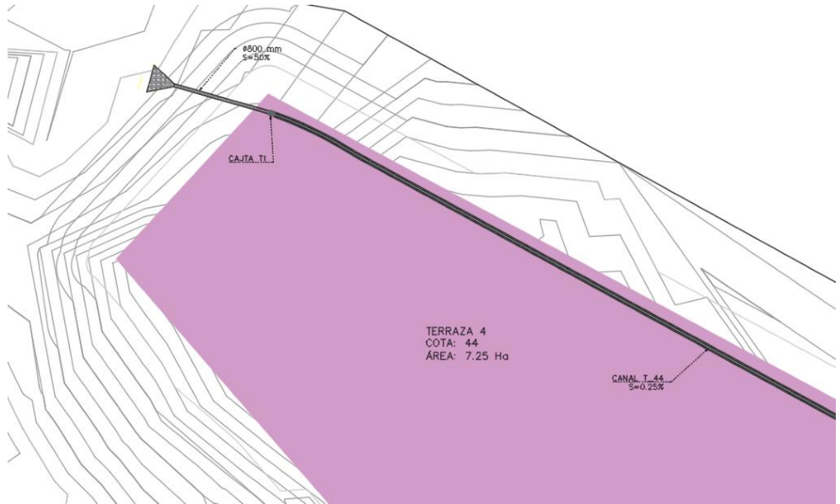
Figura 3.14 Conducción de agua (Terraza 4)
