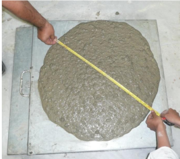
c) MEDICION DE DIAMETRO FINAL
