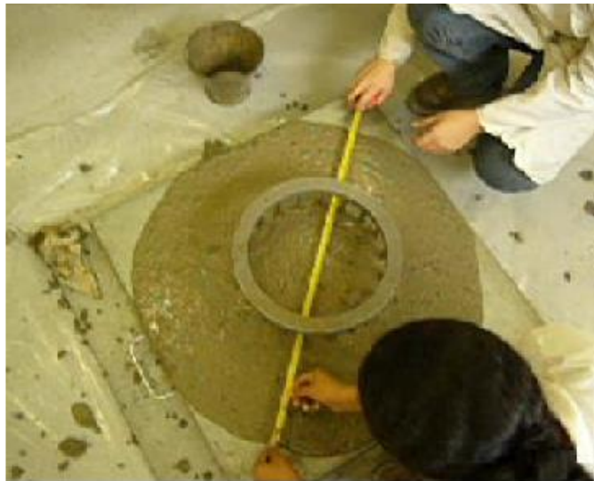
e) MEDIDAS HORIZONTALES – DIAMETRO FINAL
