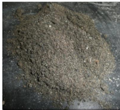
a) Arena a) Arena natural de río
