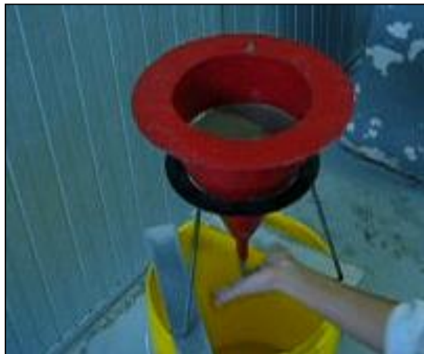
FIGURA 5.1 MEDICION DE FLUIDEZ DE CONO
