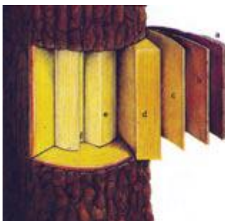
FIGURA 3.2 ANÁLISIS ESTRUCTURAL DEL TRONCO DE ÁRBOL: A) CORTEZA, B) LIBER, C) CÁMBIUM, D) ALBURA, E) DURAMEN, F) MÉDULA O CORAZÓN
