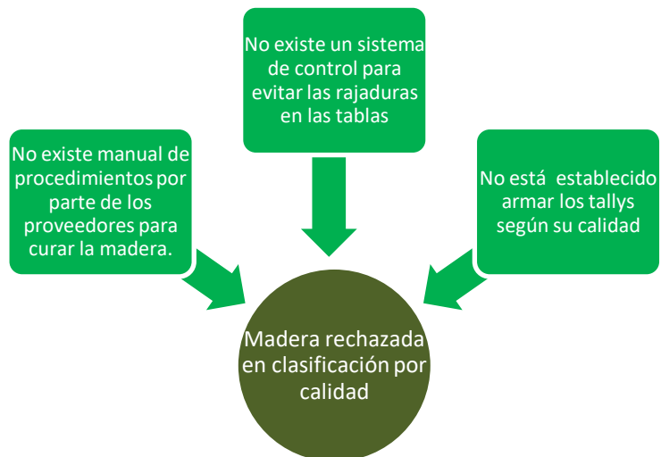
FIGURA 3.16 CAUSAS RAÍZ MADERA RECHAZADA EN CLASIFICACIÓN POR CALIDAD
