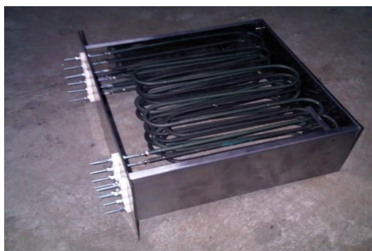
FIGURA 4.25 SET DE RESISTENCIAS ADICIONAL
