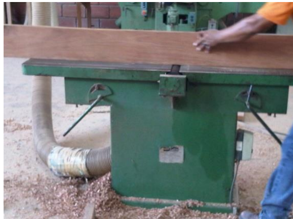
FIGURA 3.5 PROCESO DE CANTEADO
