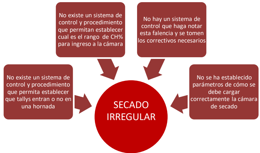
FIGURA 3.15 CAUSAS RAÍZ DEL SECADO IRREGULAR
