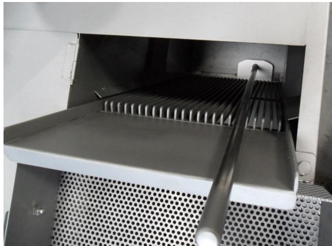
Figura 2.6. Rejilla de cribado manual. Fuente: Synertech, 2021
