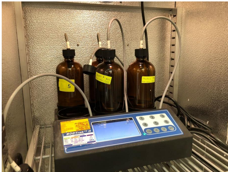
Figura A.6. Ensayo para la DBO5.
