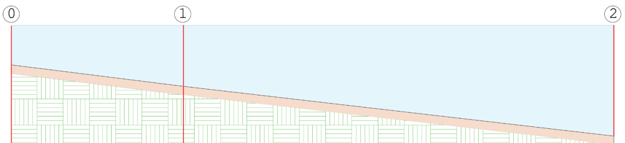
Figura 3.10. Perfil longitudinal de cada celda de humedal artificial. Fuente: Elaboración propia.
