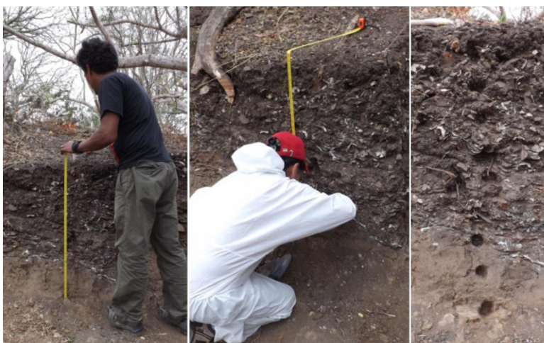
Figura 4.2. Muestreo de sedimentos con barrenos horizontales en perfiles estratigráficos, sitio La Pólvara, Isla Puná.
