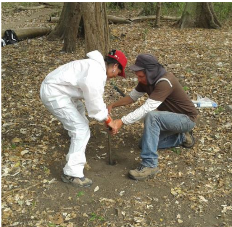
Figura 4.3. Extracción de núcleo de sedimento con barreno vertical y desde la superficie actual, Núcleo Llano La Pólvara, Isla Puná.
