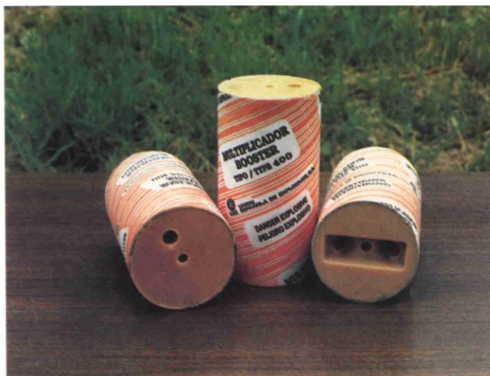
Figura 1. 34 Multiplicador de pentolita de 400 g. (Cortesía de UEE, S.A.)
