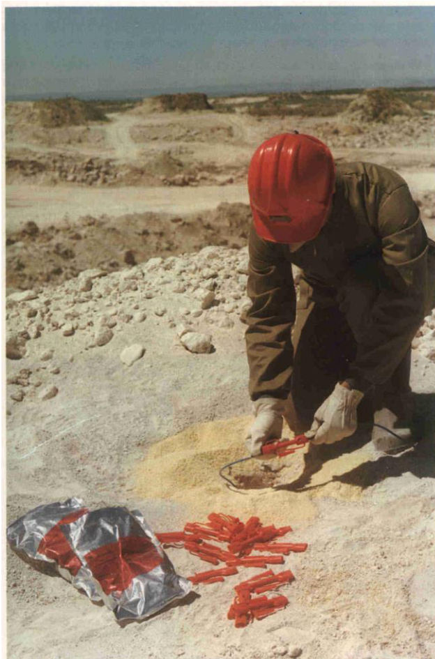
Figura 1. 32 Secuenciación de una voladura a cielo abierto con relés de microrretardo de 15 ms. (color rojo). (Cortesía de UEE, S.A.)
