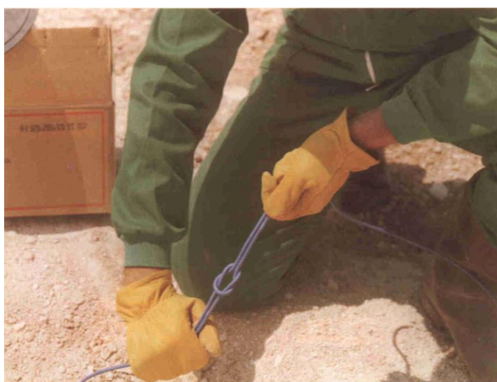
Figura 1. 28 Nudo de conexión entre ramales de cordón detonante (Cortesía de UEE, S.A.)
