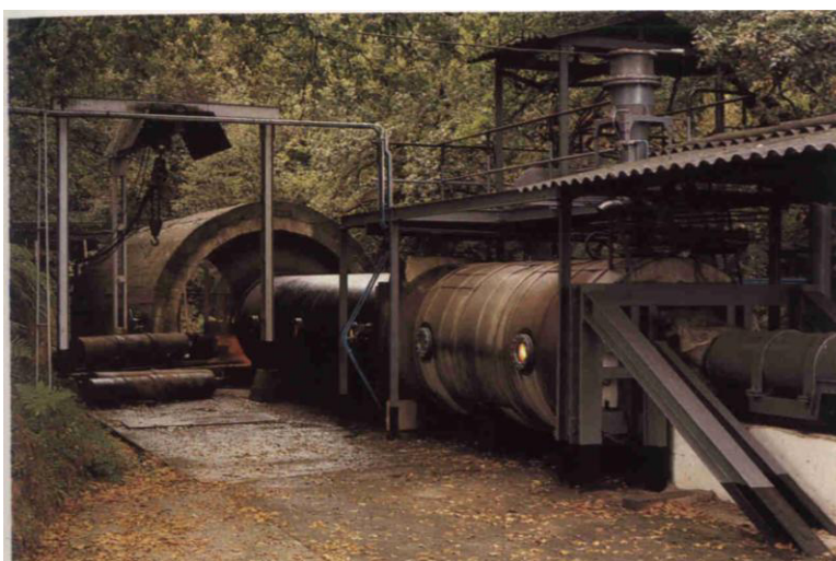
Figura 1. 10 Galería de pruebas para explosivos de seguridad. Campo de tiro de ATXE (Cortesía de UEE, S.A.)
