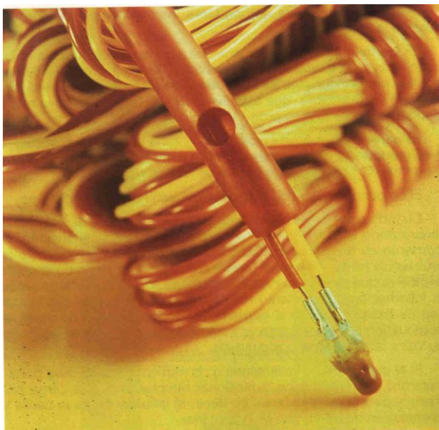
Figura 1. 30 Detalle de la cerilla de un detonador eléctrico tipo S y de su ventana antiestática (Cortesía de UEE, S.A.)
