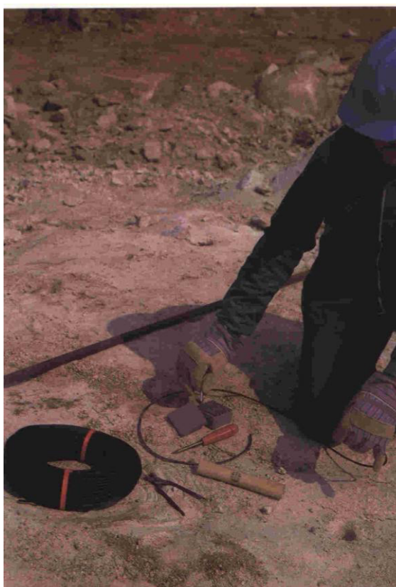
Figura 1. 25 Accesorios para pega con mecha lenta: punzón, tenacillas, mecha lenta y detonadores. (Cortesía de UEE, S.A.)
