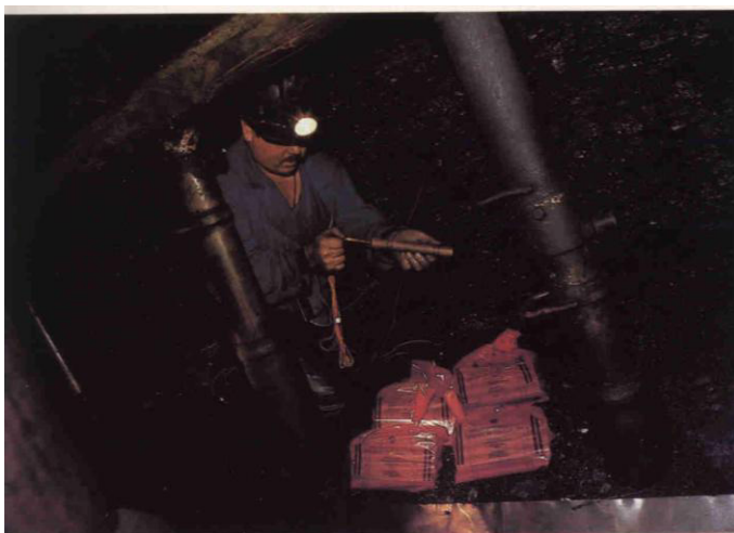
Figura 1. 11 Cebado de un cartucho para voladura de arranque de carbón (Cortesía de UEE, S.A.)
