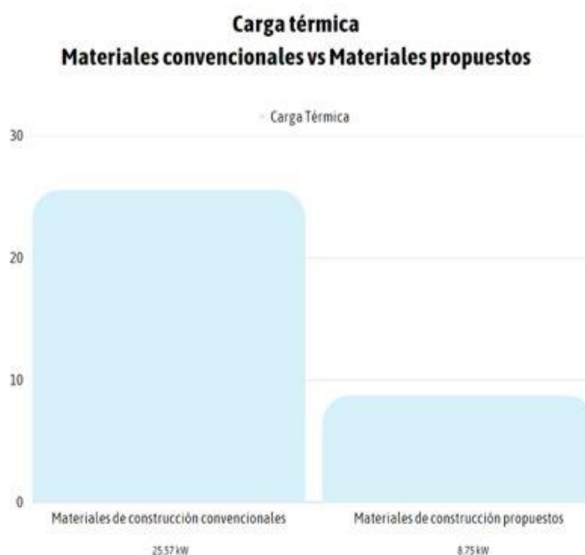
Figura 3.11 Carga térmica materiales convencionales vs materiales propuestos
