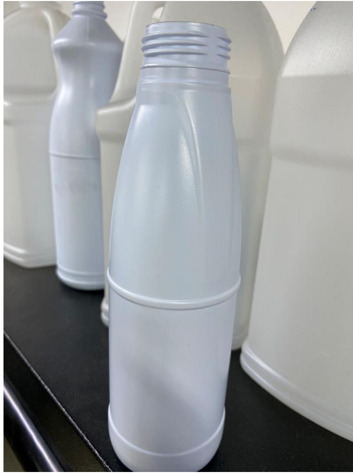
Figura B.11. Envase sin defectos superficiales.
