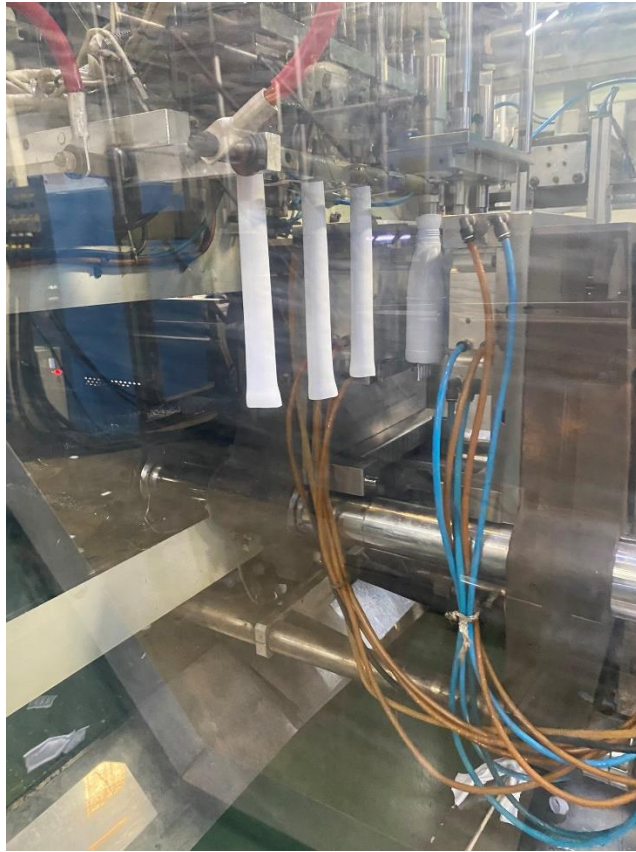
Figura B.3. Expulsión del parison
