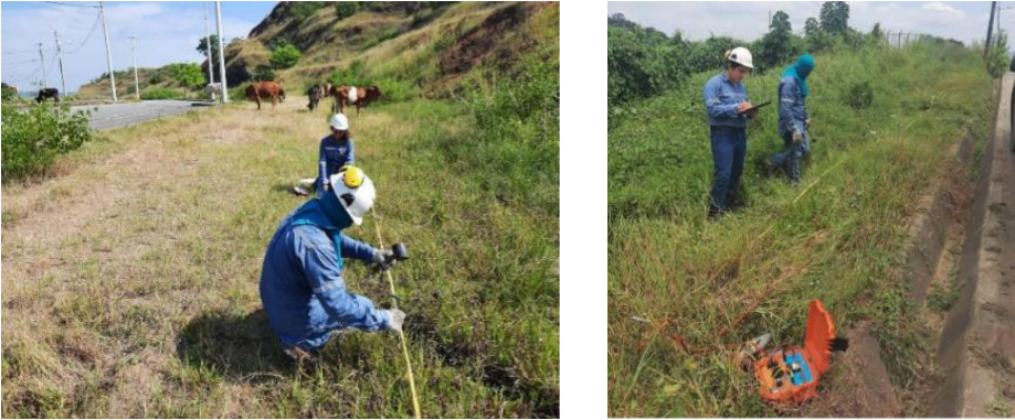
Figura 1.2. Mediciones de resistividad en el campo
