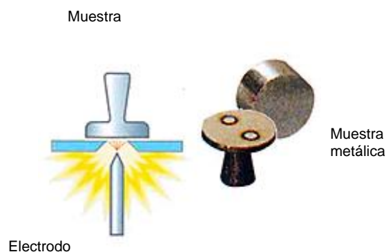
Figura 2.3. Análisis de muestra metálica por OES
