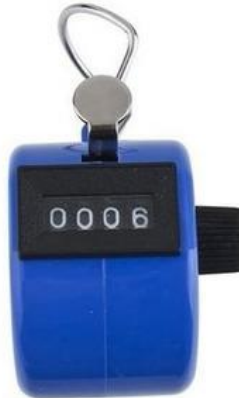
Figura 2.13 Contador mecánico de 4 dígitos
