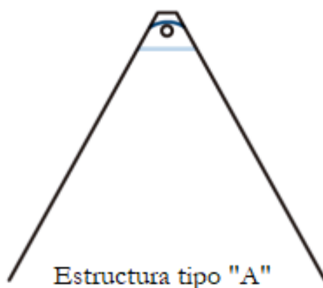
Figura 3.3 Estructura propuesta para el soporte del receptor
