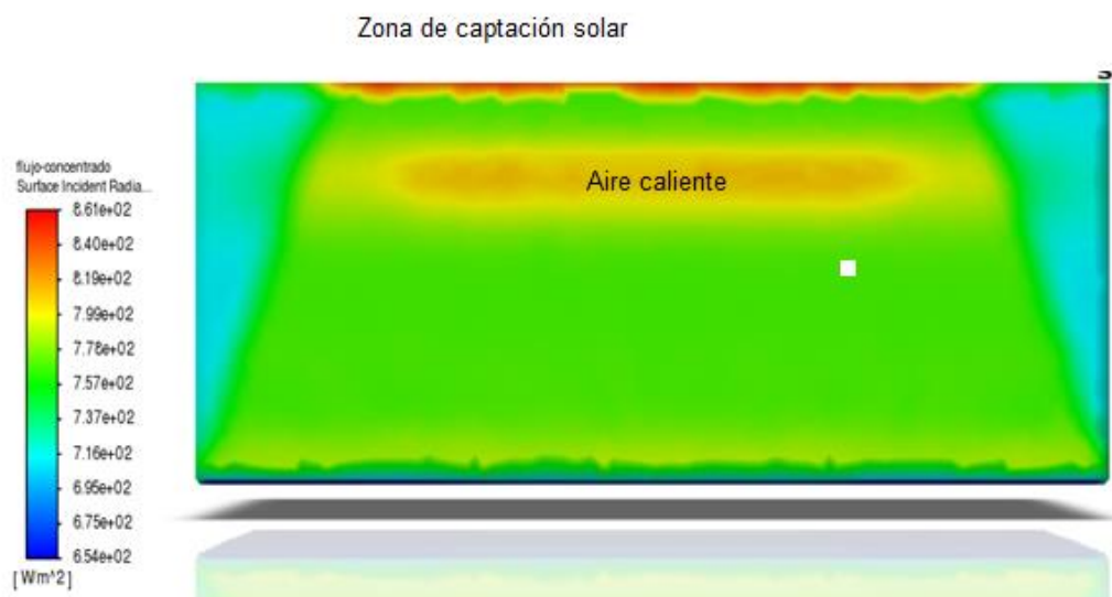
Figura 4.10 Vista lateral del flujo de calor en el concentrador lineal Fresnel
