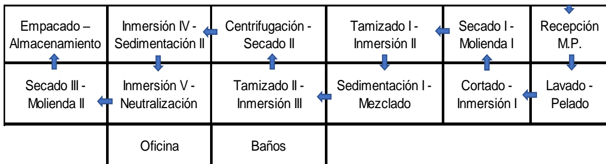
Figura 3. 8 Layout generado por el software CORELAP de planta productora de almidón modificado de banana [Elaboración propia]
