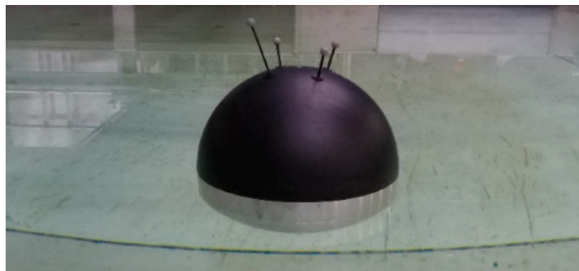
Figura 2.6 Modelo esférico utilizado para el experimento de decremento logarítmico
