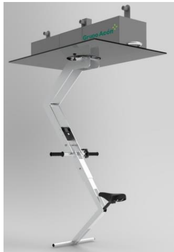
Figura 1.5. Máquina en forma de Z para transportar banano mediante el uso de cable vía
