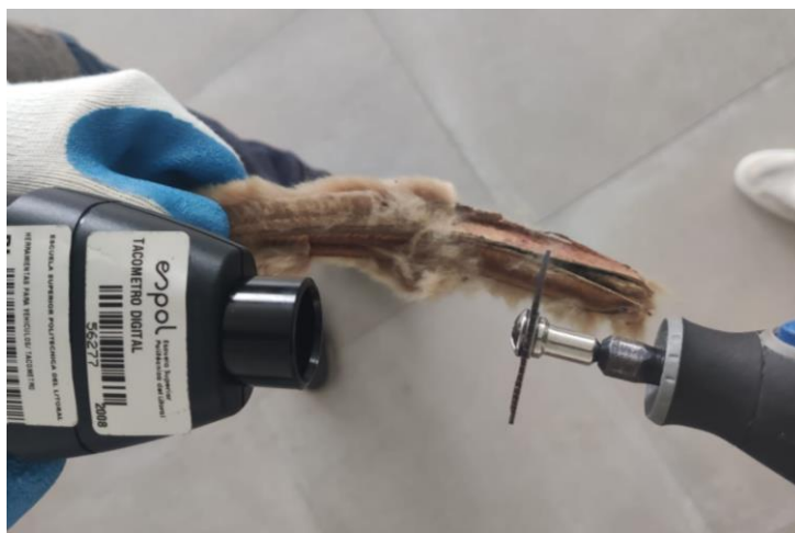
Figura 2.15 Prueba realizada con la sierra de 50 mm
