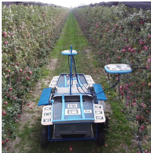
Figura 1.12 Vehículo y drones recolectores de manzanas [15]
