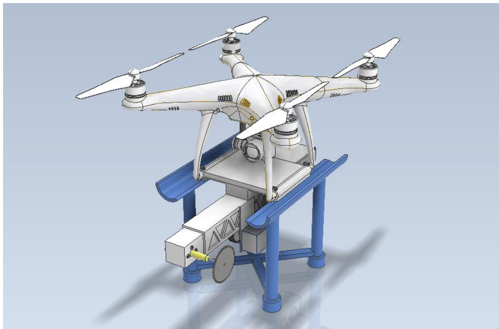
Figura 3.3 Dron Phantom 4 pro v2.0 con accesorio de corte retraído en la estación base de despegue
