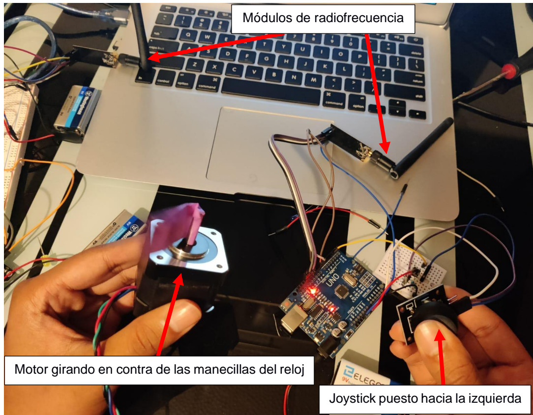
Figura 3.10 Circuito de control remoto y actuadores en funcionamiento
