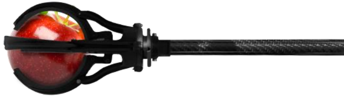
Figura 1.13 Sistema de agarre del dron recolector de manzanas [16]
