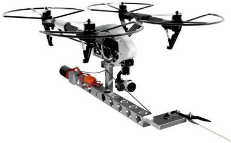
Figura 1.15 Dron diseñado para podar árboles [18]
