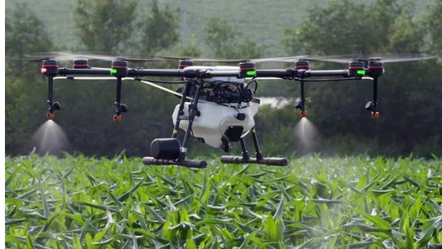
Figura 1.10 Dron aplicado a un sistema de fumigación de cultivos
