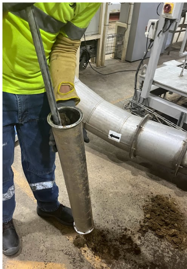
Figura 2.19 Limpieza del tubo densificador Fuente: Elaboración propia
