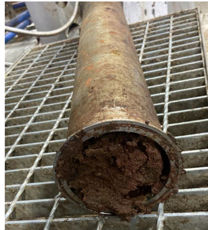
Figura 2.19 Limpieza del tubo densificador Fuente: Elaboración propia
