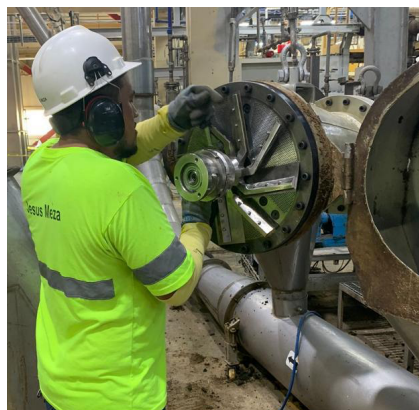
Figura 2.17 Calibración de cuchillas
