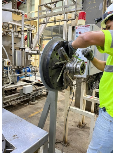
Figura 2.26 Base de molde instalada Fuente: Elaboración propia
