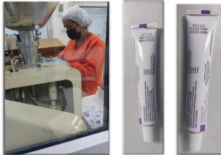
Figura 2.24 Recalibración y pérdida de tubos por Recalibración
