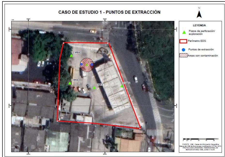
Gráfico 4.12.- Esquema de ubicación de los pozos de remediación del caso 1.
