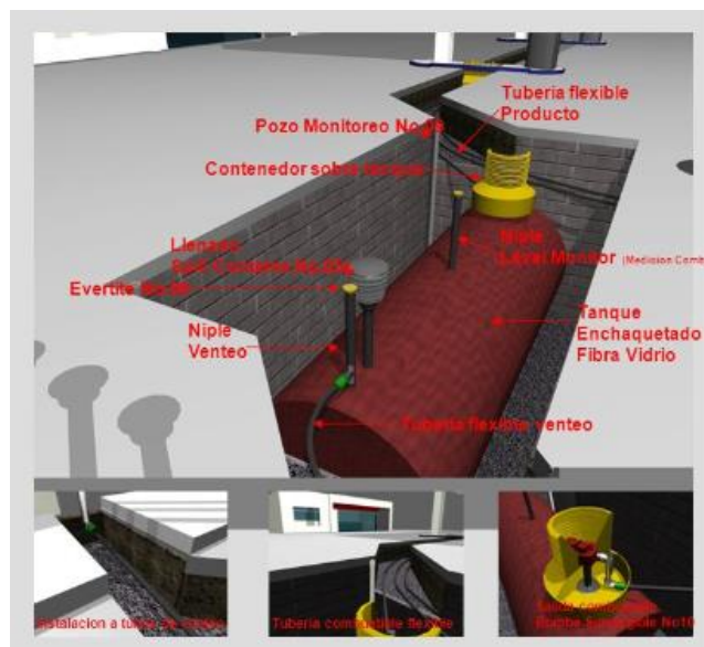
Gráfico 4.7.- Tanques de combustible y sus complementos
