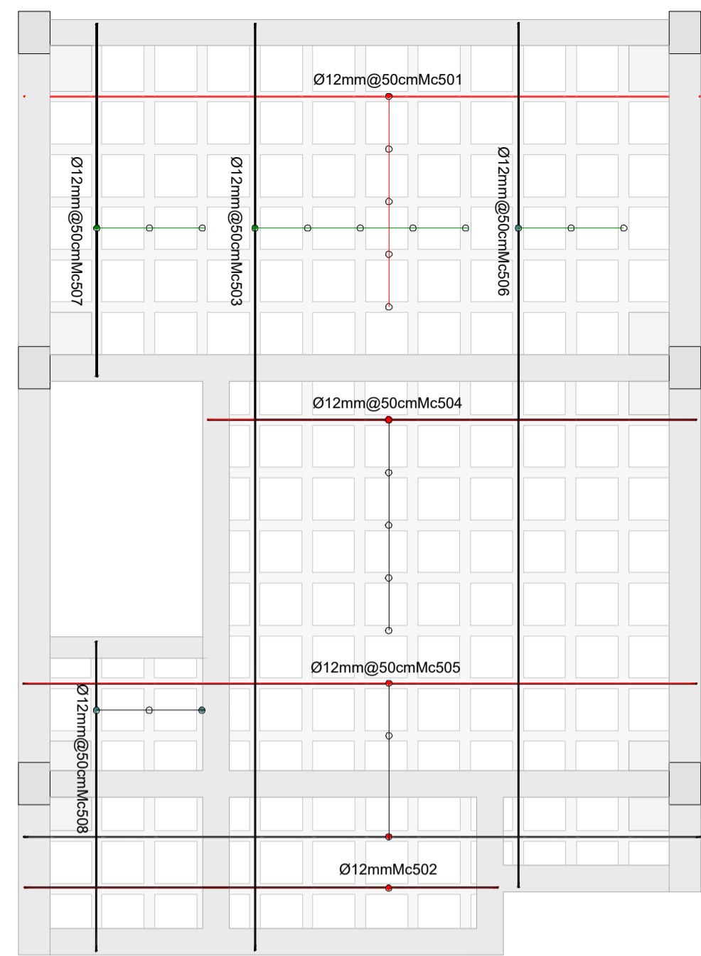
N+2.75 ARMADO INFERIOR DE LOSA ESC 1 : 50
