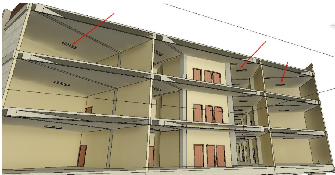
FIGURA PLANO 5. PLANO ELÉCTRICO ILUMINARIAS. 3D.
