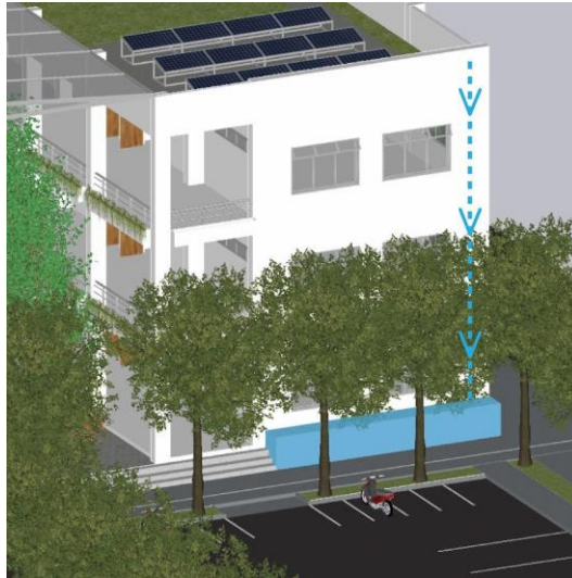
FIGURA 13. PLANO SISTEMA DE ALMACENAMIENTO DE AGUA.LLUVIAS.
