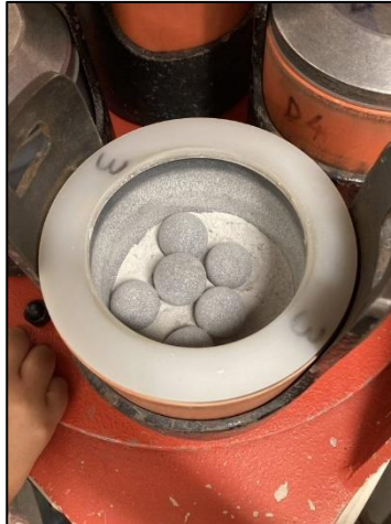
Figura 3.11 Pulverización de la muestra con las bolas pequeñas de ágata.
