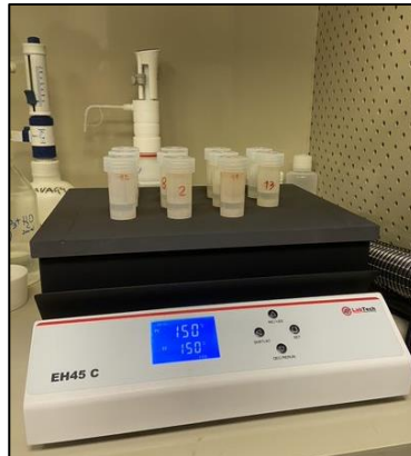
Figura 3.13 Proceso de calentado de la disolución de las muestras para análisis químico
