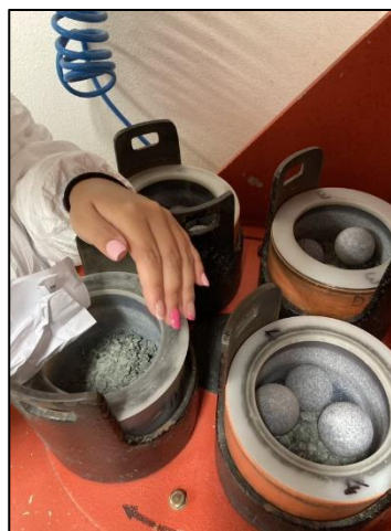
Figura 3.10 Pulverización de la muestra con las bolas grandes de ágata.
