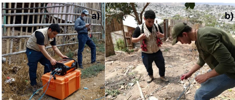
Figura 3.22 Configuración de la prospección mediante sísmica de refracción.
