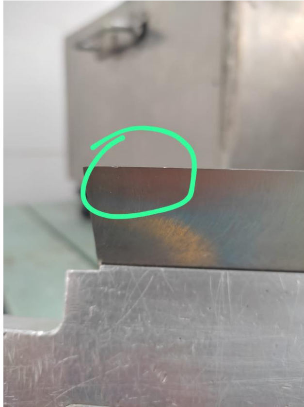
Figura 2.47 Fisuras halladas en cuchilla untadora
