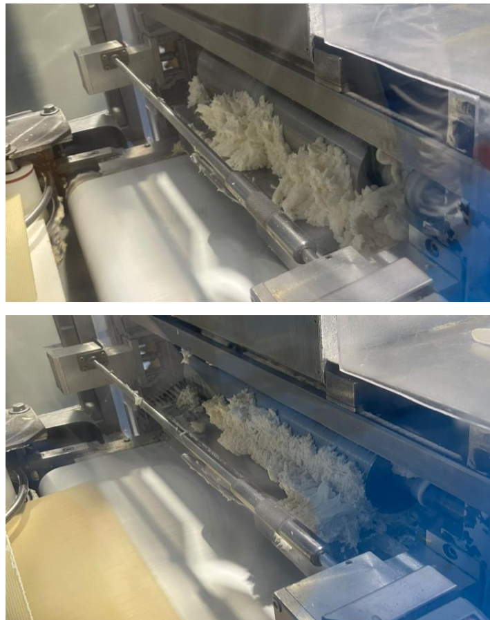
Figura 2.45 Acumulación de crema en rodillos untadores
