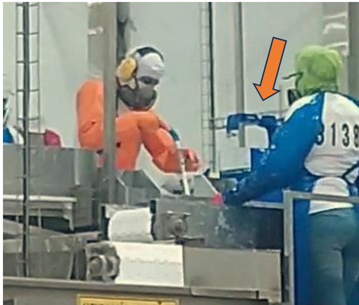
Figura 28 Captura de video, donde se evidencia la causa: enjabonado durante el cepillado.
