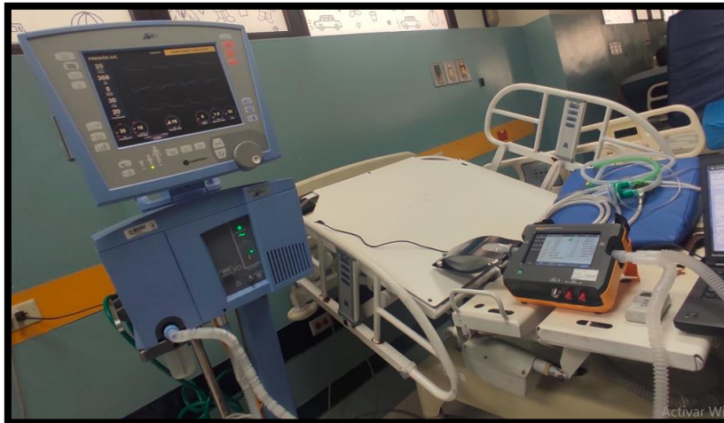
Figura 3.17 Prueba de ensayo control por presión
