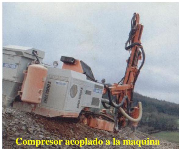
**Compresor acoplado a la maquina**
