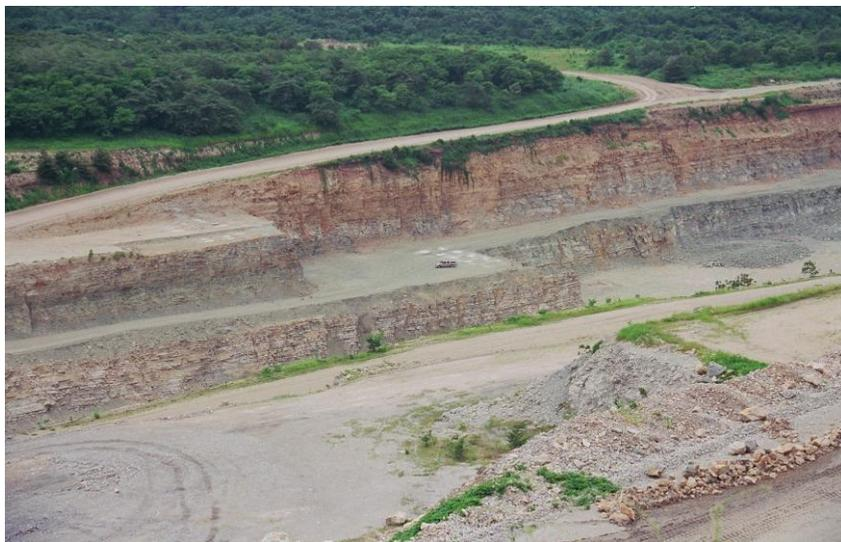
**Altura del banco utilizado en la explotación de caliza**
