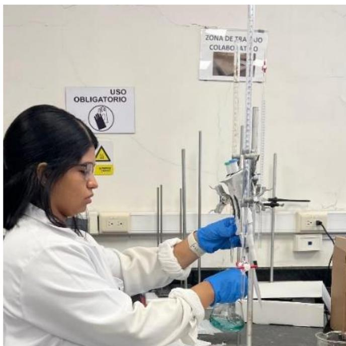
**Figura 2.13 Análisis de iones mediante titulación volumétrica en laboratorio de sanitaria de ESPOL [Urdánigo y Verdezoto, 2023].**
