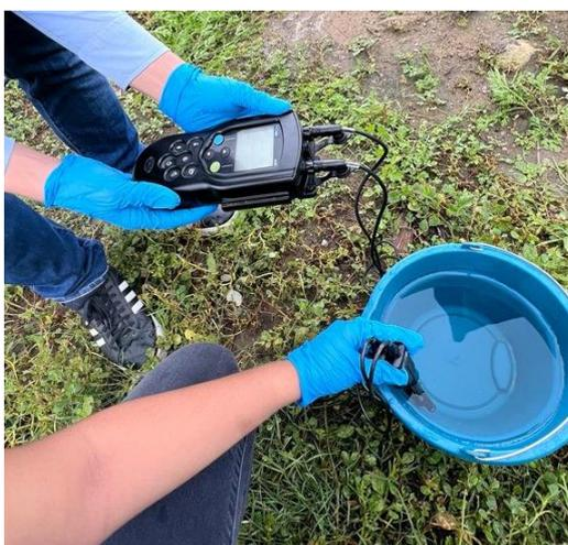
**Figura 2.12 Medición de parámetros fisicoquímicos in situ del agua del pozo “Adela” [Urdánigo y Verdezoto, 2023].**
