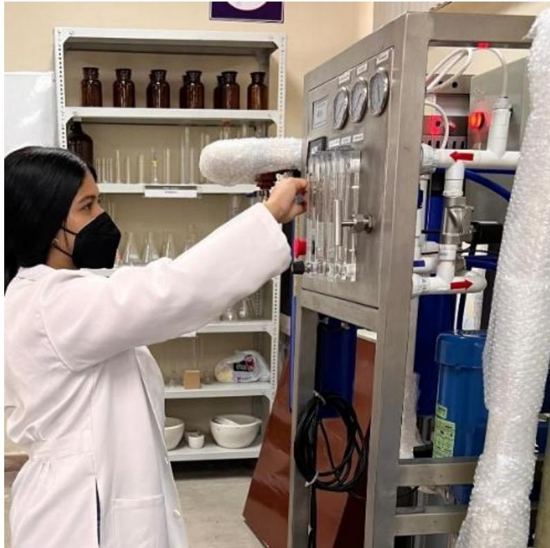
**Figura 2.16** Panel de control de planta piloto de ósmosis inversa [Urdánigo y Verdezoto, 2023].
