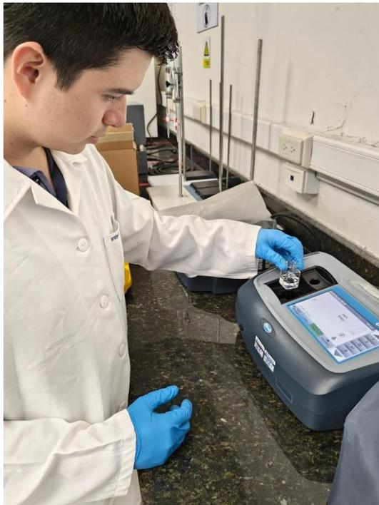
**Figura 2.14 Análisis de iones mediante espectrofotometría en laboratorio de sanitaria de ESPOL [Urdánigo y Verdezoto, 2023].**
