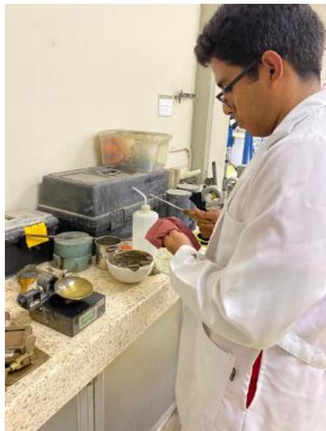
**Figura 2.12: Ejecución del ensayo de límites de Atterberg.**
