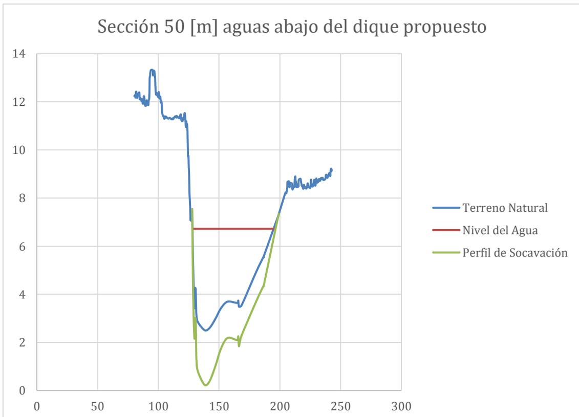
**Figura 6.10 Sección 50 metros aguas abajo del dique propuesto**
