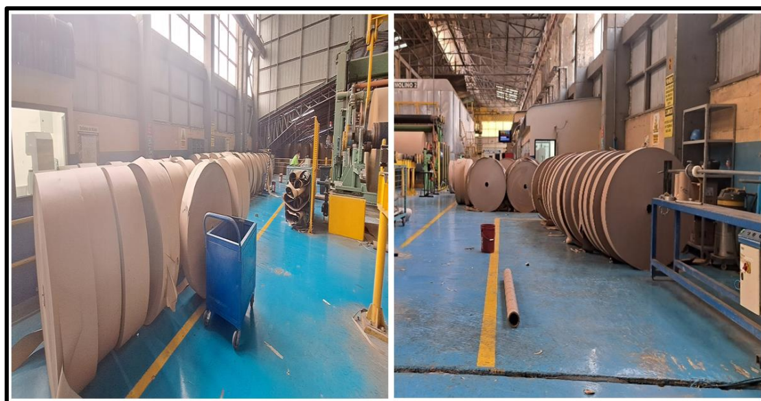
Figura 11 acumulación de bobinas de papel Kraft sobrantes del proceso
