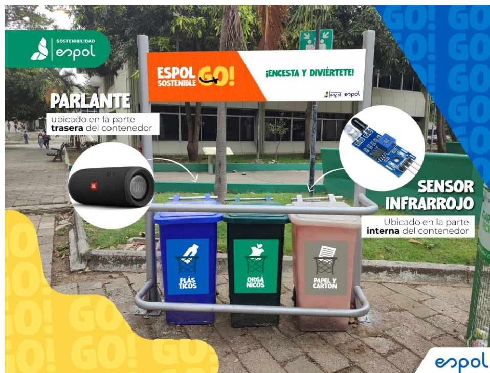
Figura 35. Prototipo de diseño e instalación para sensor y audio
