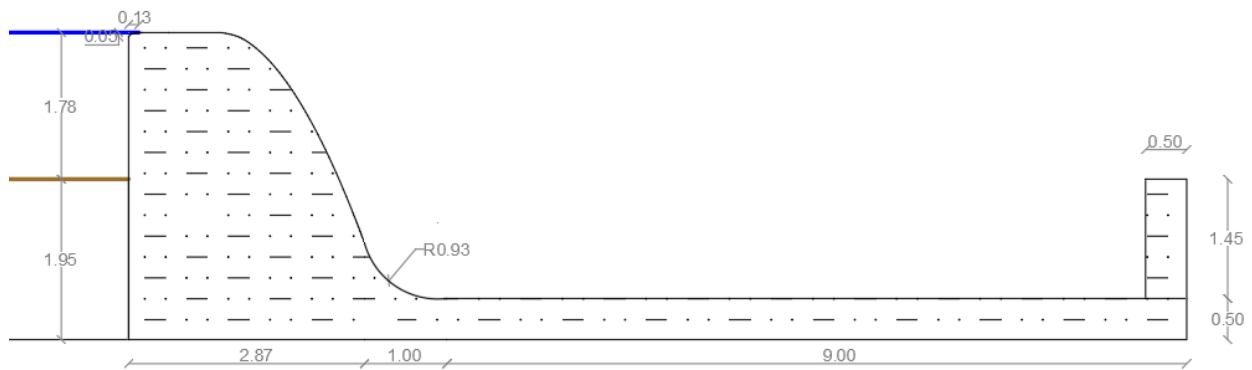
Figura 3.21 Geometría del cimacio lateral y las protecciones para el resalto hidráulico
