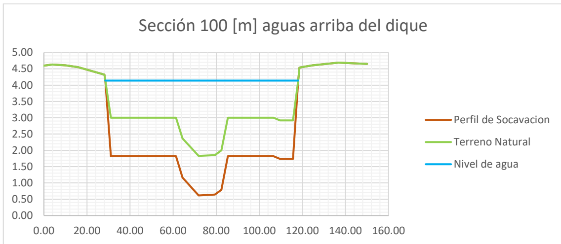
Figura 6.8 Sección 100 metros aguas arriba del dique colocado
