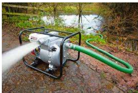
Figura 4. Extracción por bombeo (Fuente: MABA Water).
