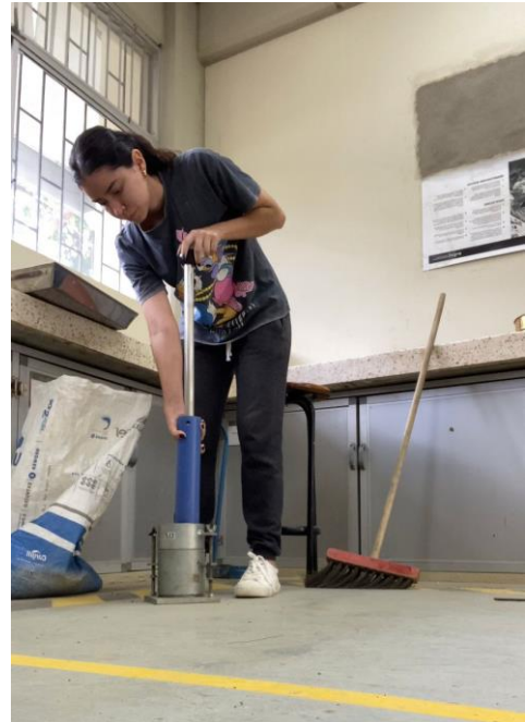
Figura 2.15 Compactación con martillo de 5lb (Demera, 2024)
