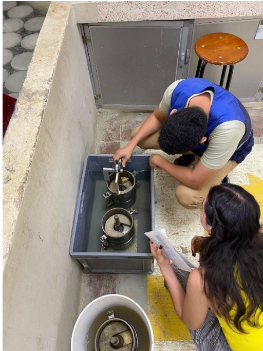
Figura 2.24 Toma de medidas iniciales de hinchamiento (Demera, 2024)
