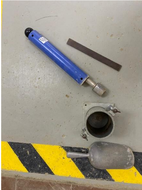
Figura 2.14 Materiales a usar para la compactación (Demera, 2024)
