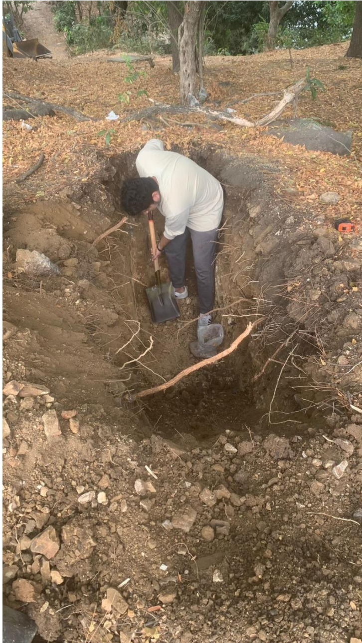
Excavación para el estudio del suelo
