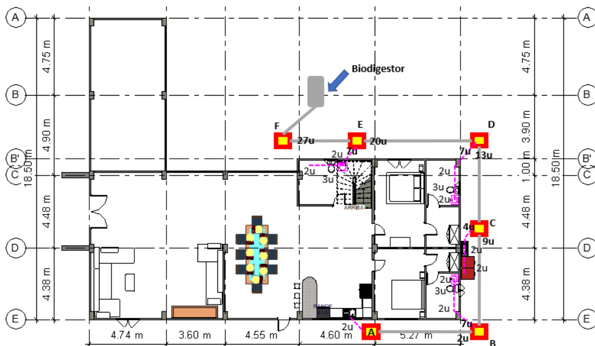
Figura 93 Bosquejo de unidades de descarga acumulada de los colectores para aguas servidas
