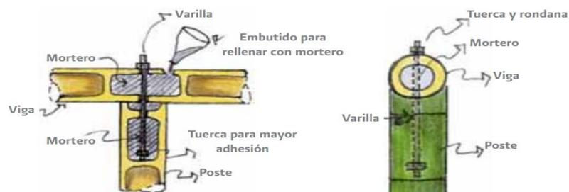
*Nota:* En esta figura se detalla el proceso de inserción de mortero para una conexión empernada [NEC]
